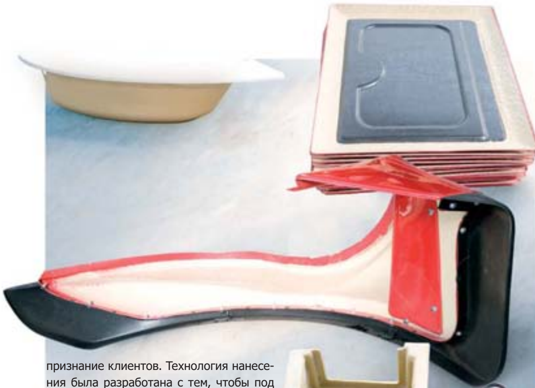
Элементы оснащения тракторов и санитарные изделия, упрочненные распылением полиуретана
