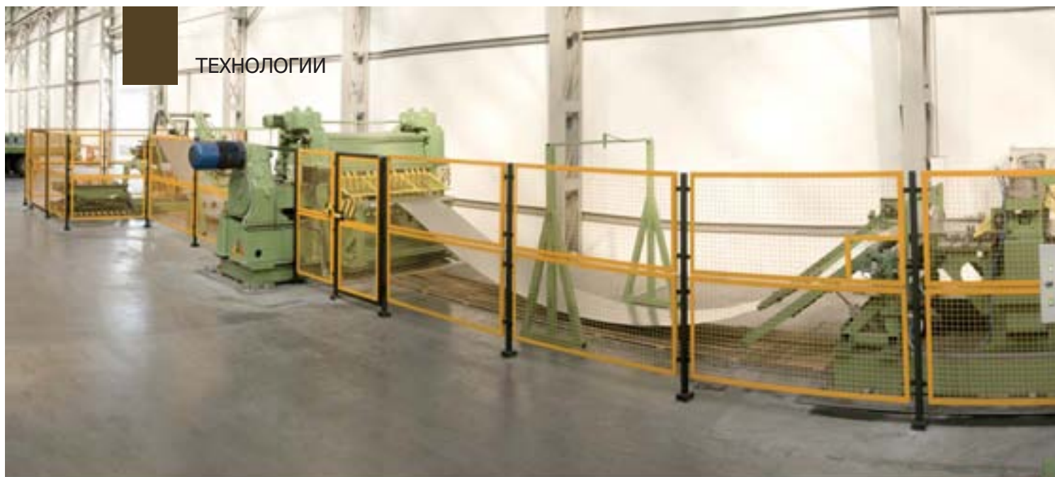
Линия резки металла, полностью оснащенная системами безопасности
