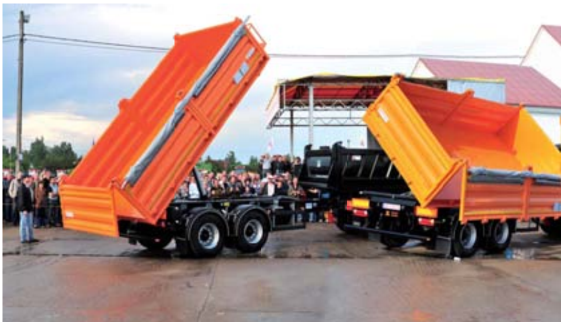
Презентация новинок 2009 г. - Прицеп-самосвал PS2100 с трехсторонней разгрузкой, с центральным расположением осей
