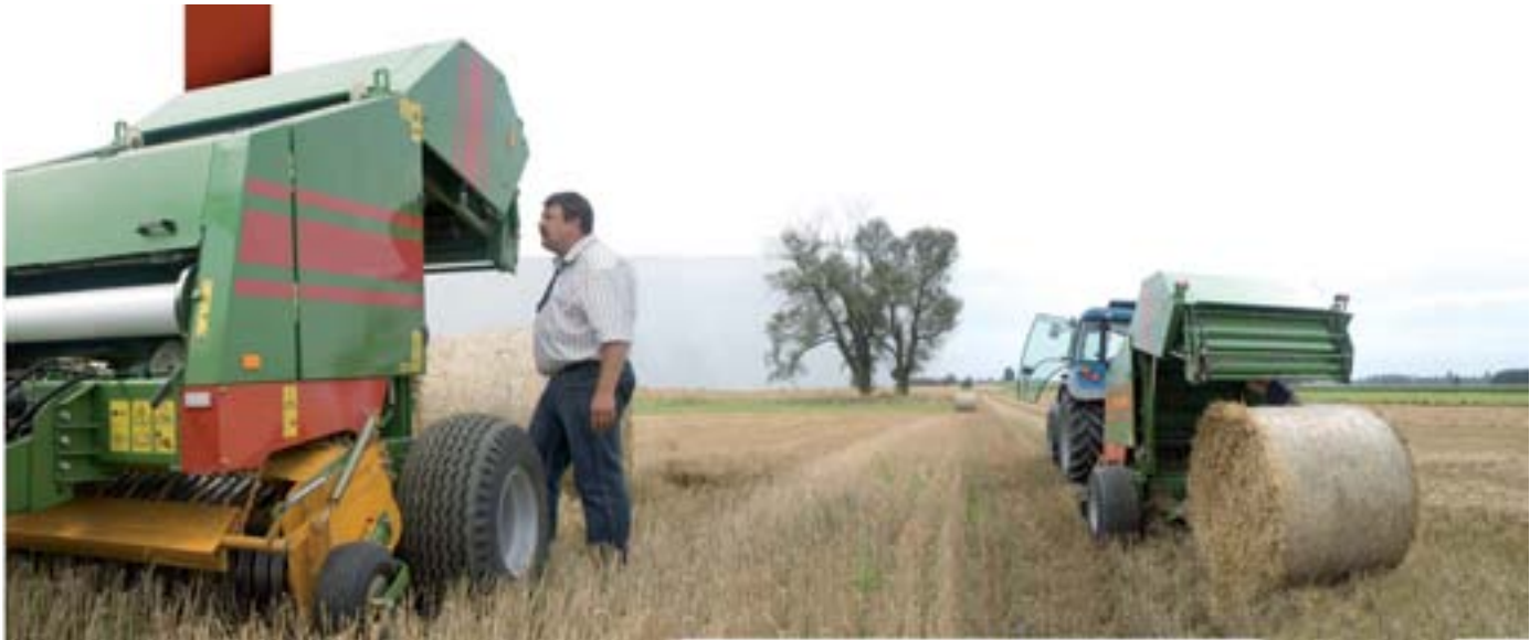
Пресс-подборщик Z-500 во время выгрузки свернутого тюка
