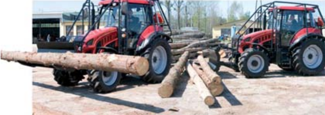
Фронтальный лесной погрузчик LCL16 позволяет убрать участок, а также ускорить работы, связанные с подготовкой лесоматериалов к погрузке
