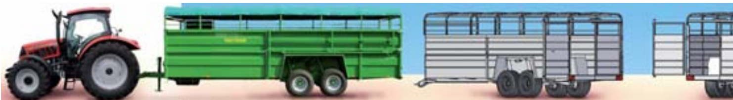
Прицеп T046/2 в базовой комплектации оборудован гидравлически опускаемой загрузочной поверхностью для облегчения погрузки животных
