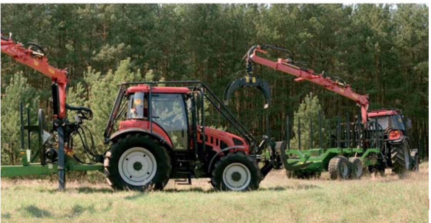
Диаметр лап захвата позволяет полностью обхватить материал диаметром от 60 до ок. 1000 мм
