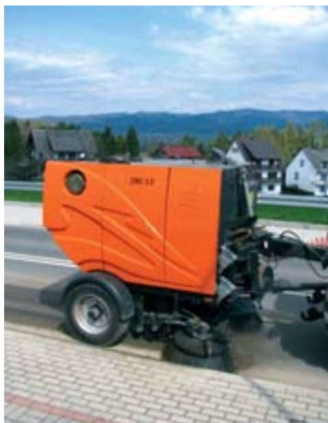
Подметально-уборочная машина ZMC 2.0 во время подметания дорог в гмине Шафляры (Малопольское воеводство)
