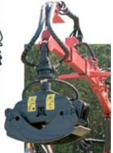
Погрузчик прицепа оснащен ротатором, обеспечивающим вращение грейфера вокруг его оси
