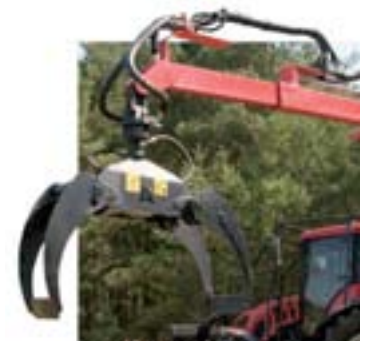
Диаметр лап захвата позволяет полностью обхватить материал диаметром от 60 до ок. 1000 мм
