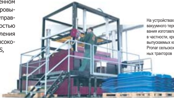
Рабочий изготавливает элементы из пластмассы методом вакуумного термоформования
