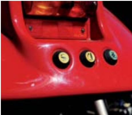
Кнопки управления грузоподъемником на левом крыле снаружи трактора
