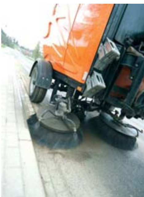
Подметальный узел подметально-уборочной машины ZMC 2.0, состоящей из оросительной системы, дисковых щеток и эксгаустера
