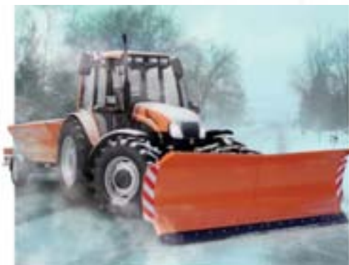
Зимний коммунальный набор ZEFIR 85K с плугом PU-3300 и разбрасывателем соли и песка T-130
