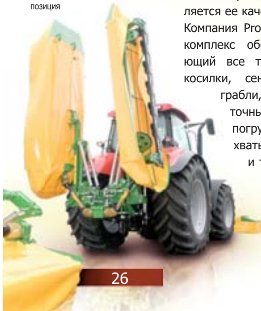
Набор косилок: PDD 810- позиция при транспортировке +PDF 290-рабочая позиция
