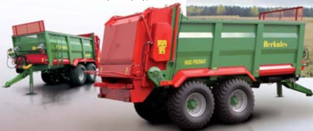
Herkules 12 с объемом кузова 11,3 м 3 и грузоподъемностью 12 тонн
