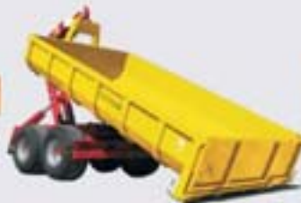
КОНТЕЙНЕРНЫЙ ПРИЦЕП ГРУЗОПОДЪЕМНОСТЬ 10 ТОНН
