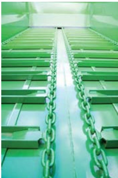
Упрочненные планки и цепи толщиной 14 мм гарантируют надежность подающего механизма
