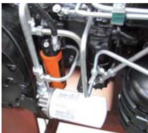
Расположение фильтров в гидравлической системе трактора P6
