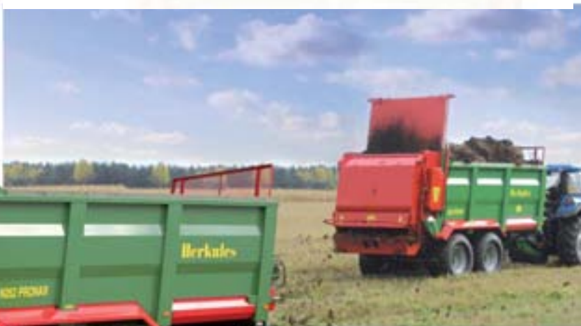
Адаптер имеет два горизонтальных барабана с двумя разбрасывающими дисками. Ширина разброса в зависимости от вида материала может достигать до 25 м
