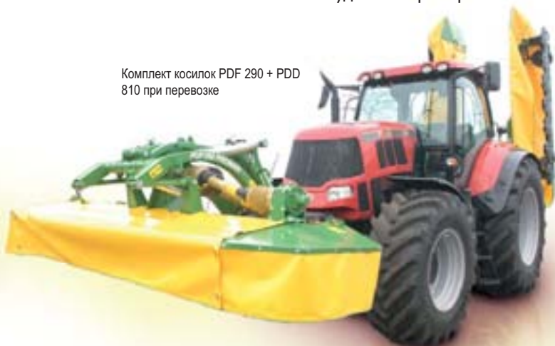
Набор косилок: PDD 810- позиция при транспортировке +PDF 290-рабочая позиция
