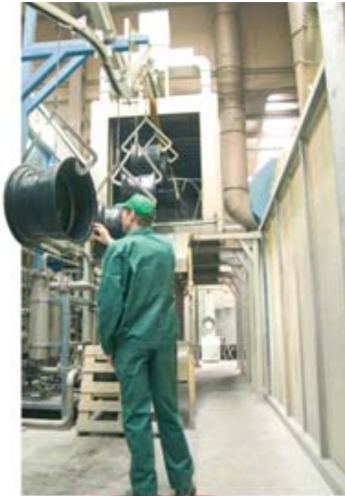
Выезд изделий из сушильного цеха после окрашивания KLT
