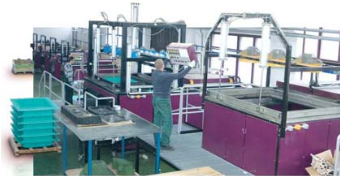
Рабочий изготавливает элементы из пластмассы методом вакуумного термоформования
